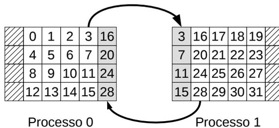
Per completare lo scambio delle colonne sul bordo il processo 0 invia ora la prima colonna della propria matrice al processo 1, che la inserisce nell'*halo* di destra; il processo 1 invia l'ultima colonna (quella di destra) della propria matrice al processo 0, che la inserisce nell'*halo* di destra.
