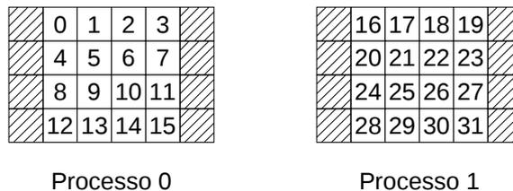
Il processo 0 deve inviare l'ultima colonna della propria matrice al processo 1, che la inserisce nell'*halo* di sinistra; analogamente, il processo 1 deve inviare la prima colonna della propria matrice al processo 0, che la inserisce nell'*halo* di destra.
